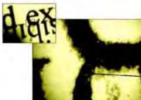
Рис. 2. Отпечатки НПВО-кристалла на поверхности текста.
