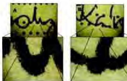
Рис. 8. А-В. Оптическое изображение печатного документа, полученное с помощью НПВО-объектива: (А) точки, отпечатанные принтером I, находятся поверх текста, написанного ручкой, (В) текст, написанный ручкой, находится поверх точек, отпечатанных принтером I.
