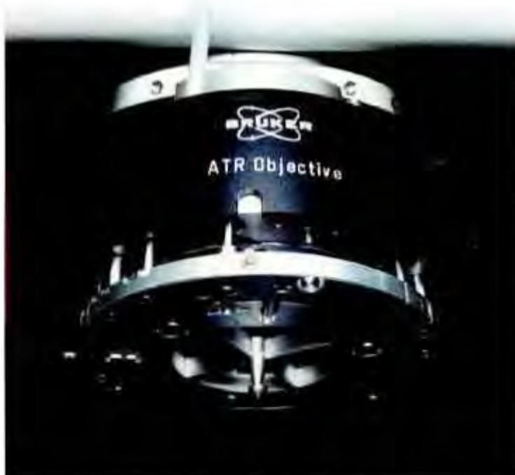
Рис. 1. 20x НПВО объектив для микроскопа BRUKER.
