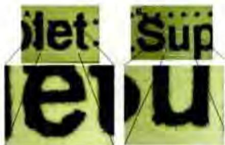
Рис. 5. А-В. Изображение печатного документа, полученное с помощью НПВО-объектива в режиме визуализации: (А) точки, напечатанные принтером I, находятся поверх текста, напечатанного принтером II, (В) напечатанный текст.
