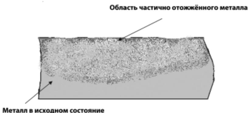
Рис 4. Состояние металла после общей поверхностной деформации (зачеканивания) и отжига.
