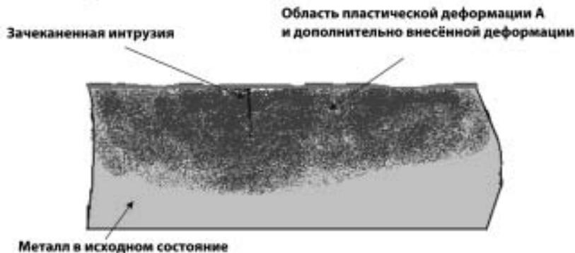
Рис 3. Состояние металла после общей поверхностной деформации (зачеканивания).
