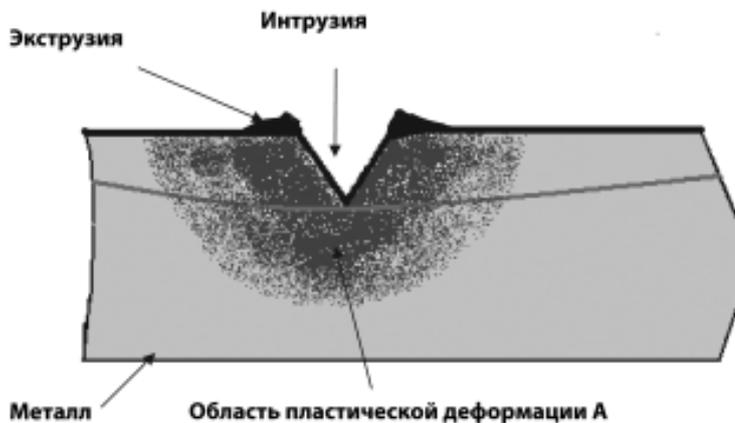
Рис 1. Состояние металла после нанесения маркировки методом деформации маркируемой поверхности. Линией красного цвета указана глубина удаления металла для уничтожения видимой части маркировки.
