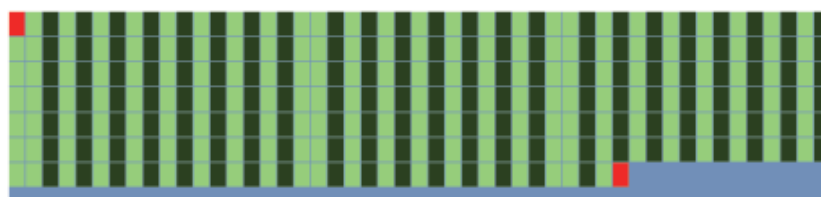
Рис. 2.5. Размещение блоков в MP3-файле с битрейтом 96 кбит/с
