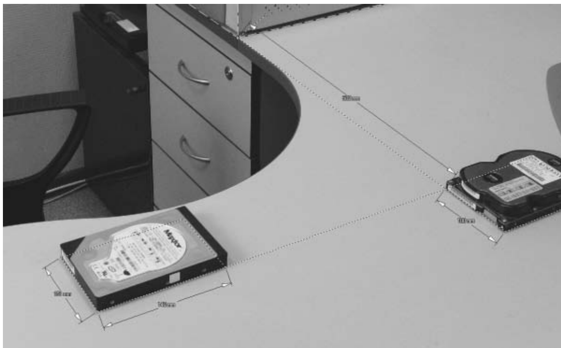
Иллюстрация 3. Измерение габаритов НЖМД и расстояния между ними
