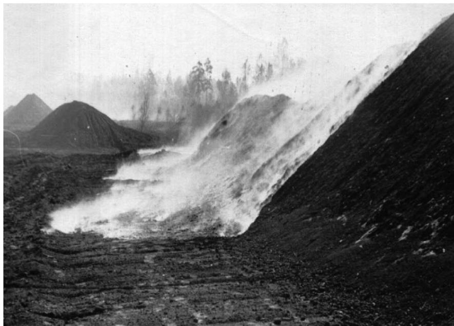
Рис. 4. Штабель торфа в процессе самовозгорания.
