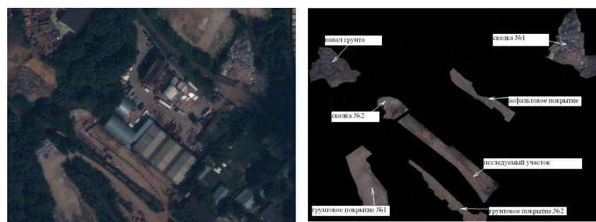
Слева - общий план места происшествия на космическом снимке в цветовой синтезе RGB 1,2,3 – цвета, близкие к натуральным; справа – результат векторизации в программе SAGA GIS. Параметры снимка: файловый формат – TIFF; пространственное разрешение – 0,5 м в пикселе; дата съемки – 06.08.2015.
